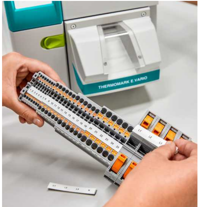
Rotulación de todo el regletero de bornas con solo dos materiales
